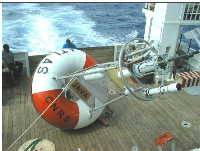
Figura 2: Bóia PIRATA utilizada na aquisição das variáveis meteorológicas e oceanográficas.
