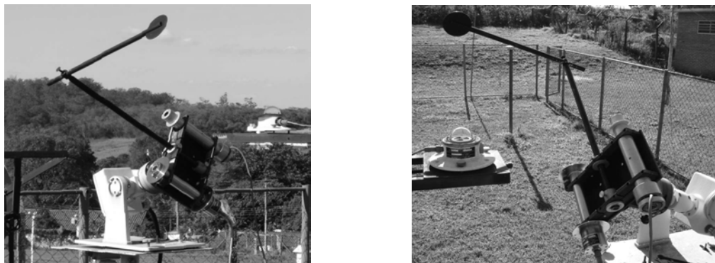
Figura 1. Pireliômetro Eppley – Detector da radiação solar direta na incidência.
