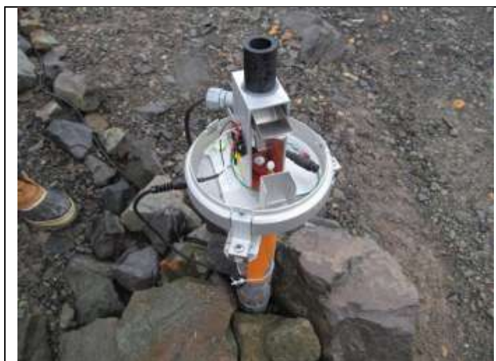
Figura 17. Foto do pluviômetro danificado após o incêndio de 2(sem a cúpula).
